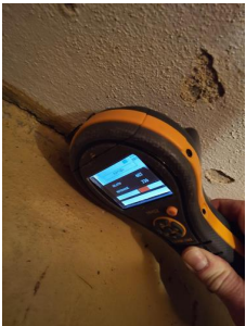
Kontroll i lukkede konstruksjoner ikke utført - Fuktsøk bod 2
